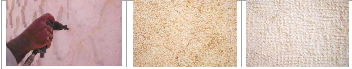
الشكل (113-1) أساليب مختلفة لمعالجة الحجر (حجر بوشادة ألي-حجر بوشادة يدوي-حجر أبيض مجلي)
